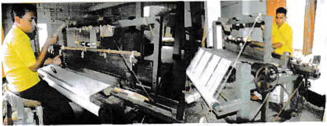
হস্তচালিত তাঁতে রেশম বস্ত্র বয়ন প্রক্রিয়া
