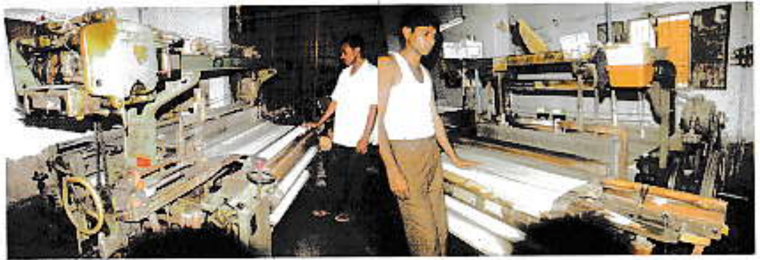
শক্তিশালিত তাঁতে রেশম বস্ত্র বয়ন
